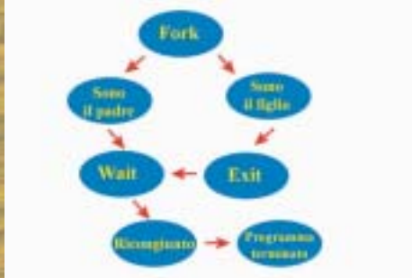
Figura 2: la sincronizzazione dei due processi.
